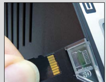
MicroSD-Karte zur Parametrisierung der i-CON pico
