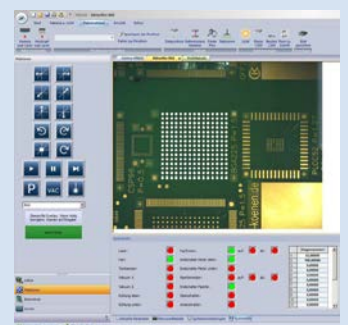
Überlagern von Bauteil und Zielposition
