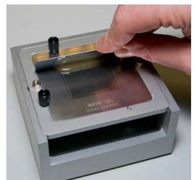
Flussmittelauftrag in Dip-Schablone
