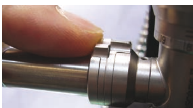
Mechanische Irisblenden zur Regulierung von Front- und Gegenlicht
