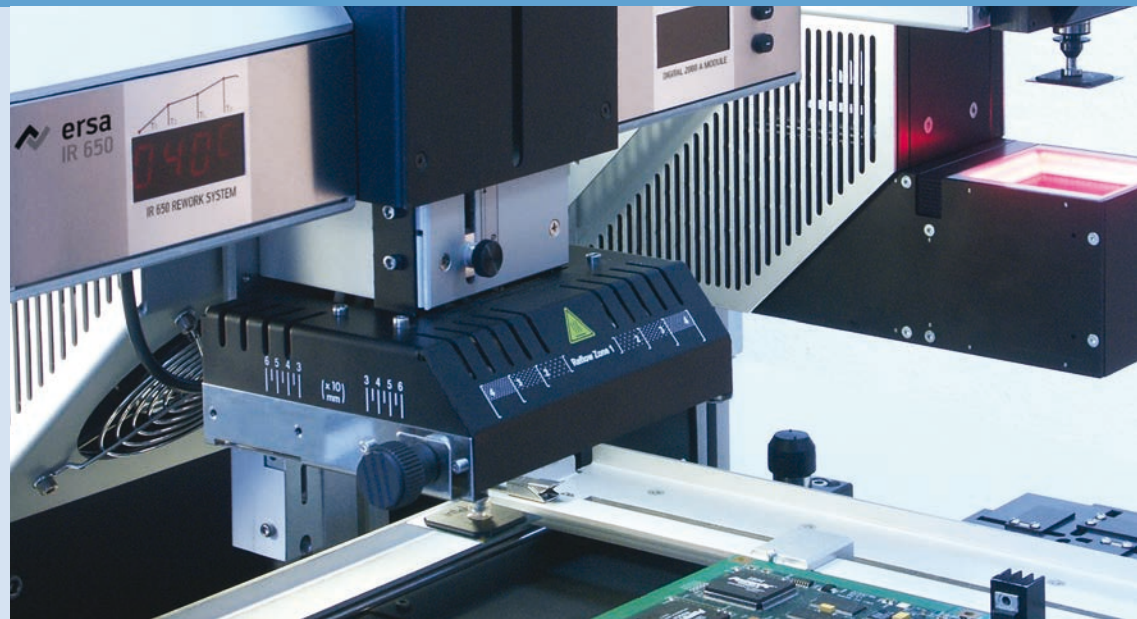
Prozesskamera zeigt das Schmelzen der Lötugeln
