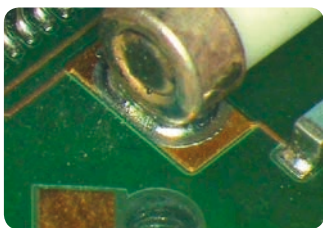
Bleifrei: fehlende Benetzung
