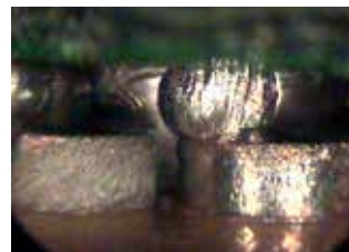
BGA: schlechte Ausrichtung
