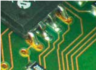
Bleifrei: fehlende Benetzung
