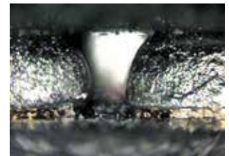
PBGA: zu wenig Wärme
