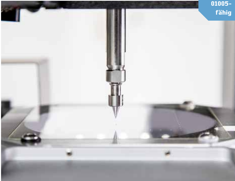
Automatisches Greifen eines 01005-Chips
