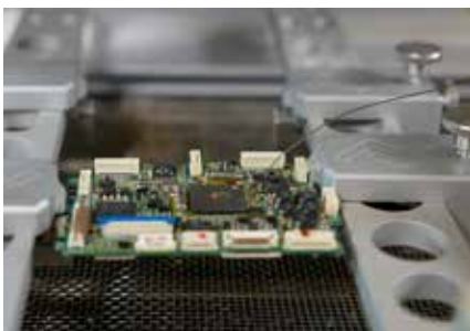
Flexible Haltesysteme passen sich der Größe und Bestückung Baugruppe an.
