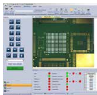
Überlagern von Bauteil und Zielposition
