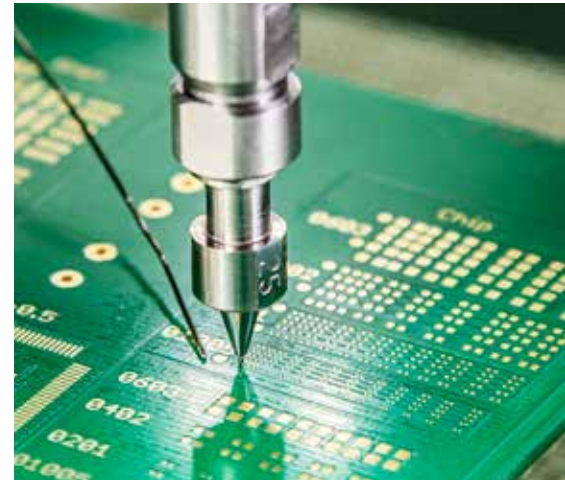
Platzierung eines 01005-Chips
