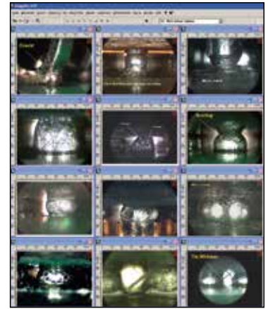
Datenbank mit Referenzbildern, Livebild mit Referenzanzeige guter und schlechter Lötergebnisse
