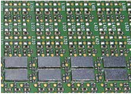
CSP, Micro-BGA 01005-, 0201-, 0402-Chips
