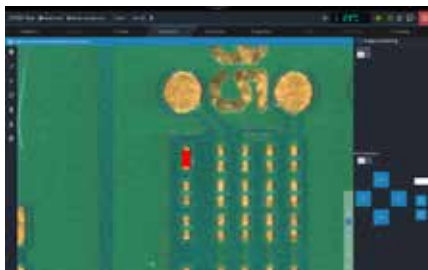
Automatisch berechnetes Overlay eines Chips der Baugröße 01005
