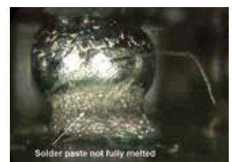
PBGA: zu wenig Wärme
