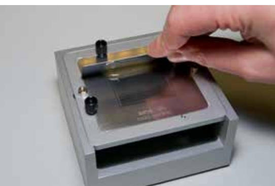
Flusmittelauftrag in Dip-Schablone
