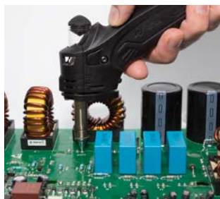
Entlöten massereicher bedrahteter Bauteile mit dem X-TOOL VARIO
