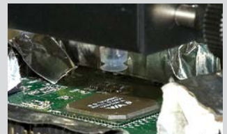
6. Einlöten des BGAs auf die vorbereitete Fläche auf der Platine
