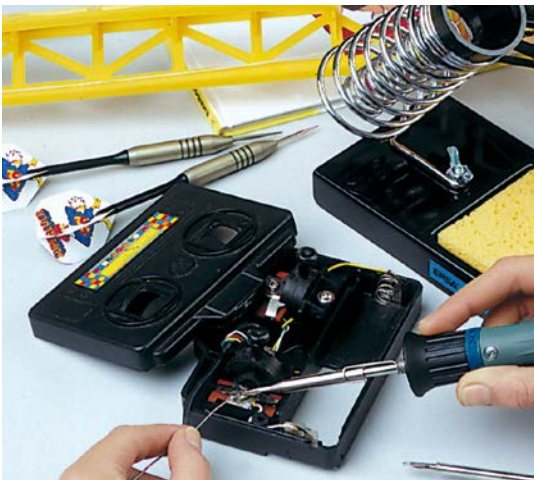
Ersa MULTITIP (15/25 W) – innenbeheizter LötKolben für kleine Lötstellen
