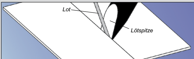
Kolbenführung beim Löten einer schmalen Naht
