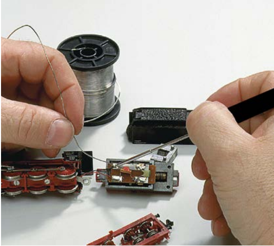
Ersa MINOR S (5 W) mit federleichten 6 g für allerfeinste Lötungen
