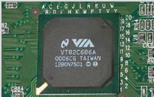
1. Ball-Grid-Array-Chipgehäuse (BGA) zunächst entlöten
