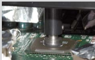
5. Platzieren des neuen Bauteils
