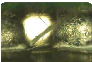
Flussmittelrückstände unter BGA
