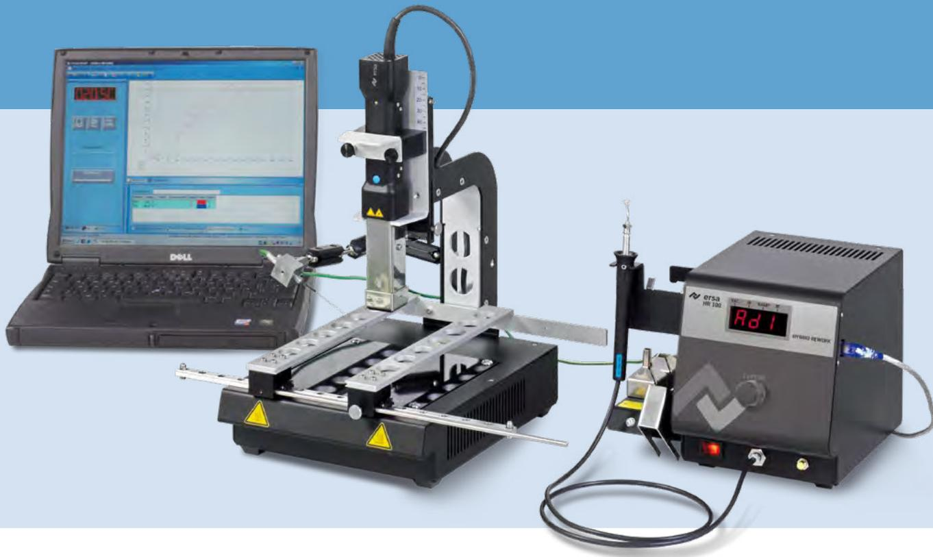
Das HR 100 verwendet Ersas revolutionäre und patentierte Hybrid-Rework-Technologie für ein sicheres Auslöten und Ersetzen von kleinen SMDs. Die mittelwellige IR-Strahlung in Kombination mit einem sanften Heißluftstrahl garantiert eine optimale Energieübertragung auf das Bauteil.
