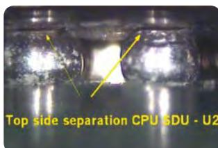
Delaminierung beim BGA-Gehäuse
