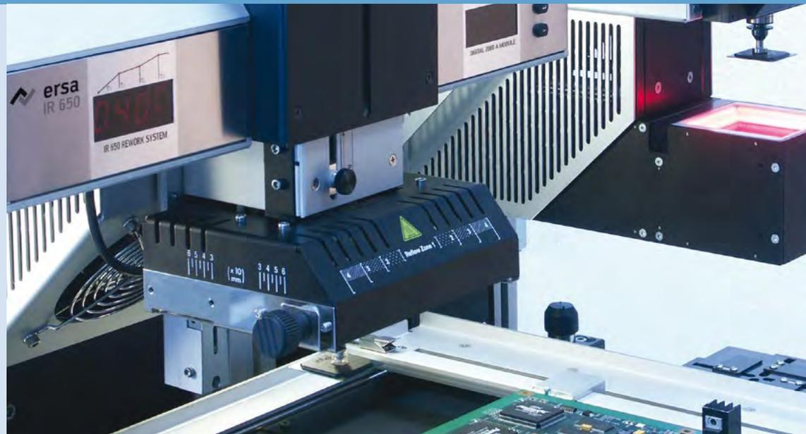
Das IR/PL 650 bietet eine sehr große Heizleistung (4.400 W) für große und komplexe Platinen. Durch den hohen Automatisierungsgrad benötigt das IR/PL 650 nur sehr wenige Anwendereingriffe, was einen stabilen und wiederholbaren Rework-Prozess bei allen Anwendungen garantiert.
