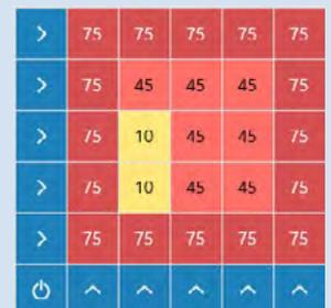
Vollflächige Heizung, erhöhte Heizleistung in der Randzone und „Cold Spot“
