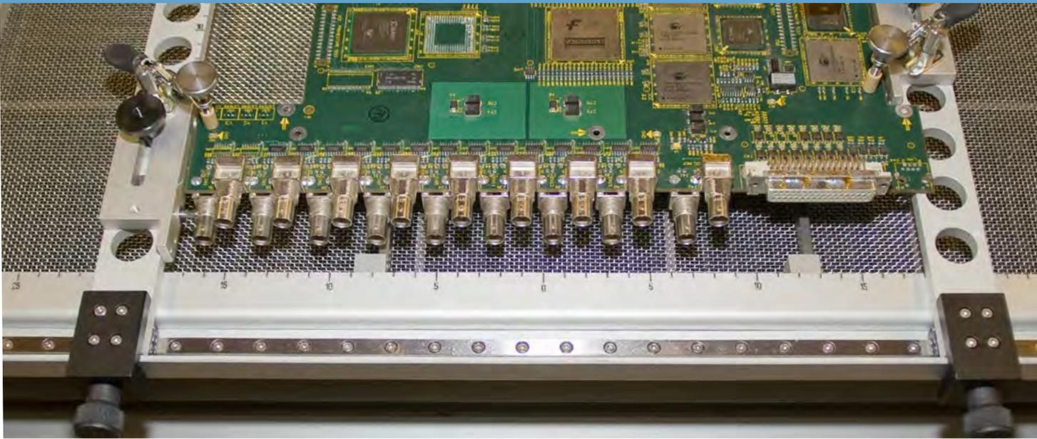
Durch das Design des Leiterplattentisches können alle Leiterplattengeometrien optimal aufgelegt werden. Ober- und unterseitige Stützschiene können einfach eingeschoben werden und sind schnell an die jeweilige Rework-Aufgabe anzupassen. Über einen 45°-Klappmechanismus kann der Tisch mit eingespannter Leiterplatte aufgeklappt werden und bietet bequemen Zugang zur Leiterplattenunterseite. So ist es für den Bediener einfach, Temperaturfühler an der Unterseite anzubringen, Stützpins
