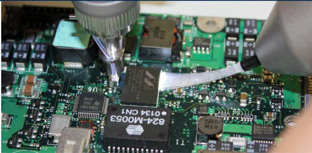
Langlebige und sehr helle, regelbare LED-Lichtquellen in beiden Optiken garantieren eine optimale Ausleuchtung der Lötstellen. Für die BGA-Inspektion unerlässlich ist ein zusätzliches LED-Faserlicht als Gegenlicht oder für die Ausleuchtung schwer zugänglicher Bereiche. Lötfehler können so schnell und einfach erkannt werden.
