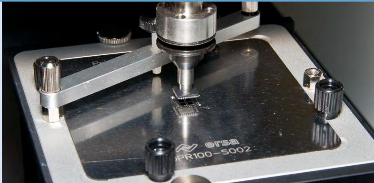
Die Ersä DIP&PRINT STATION ermöglicht dem Anwender von Ersä Rework-Systemen, die Bauteilvorbereitung (Auftrag von Lotpaste oder Flussmittel) einfach, zuverlässig und reproduzierbar vorzunehmen.
