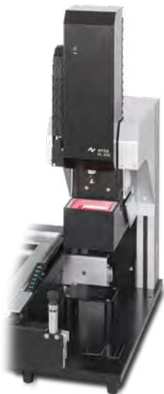
Das PL-650-Modul ist ein hochpräzises Platziersystem der zweiten Generation. Es bietet ein breites Bauteilspektrum, einen hohen Automatisierungsgrad und eine sehr gute Wiederholgenauigkeit. Ein moderner, vollautomatischer, druckgesteuerter Bestückkopf setzt das Bauteil mit der gleichen Kraft (1,5 N) ab wie ein Inline-Pick & Place-Automat.
